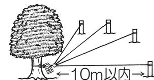
針金を本体の引抜ピンにピーンと張った状態で結び付ければセット完了。一度に数カ所の防犯管理が出来ます。
