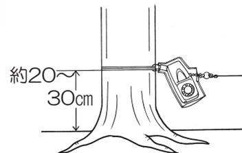
ガードしたい所に杭を立てて地上より約20~30cm位の所に針金付け固定します。
