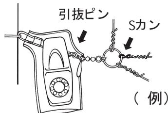
防水カバーを被せ、ネジ付ワイヤーを左上の切り込みから出して、立木や杭等に吊るします。
