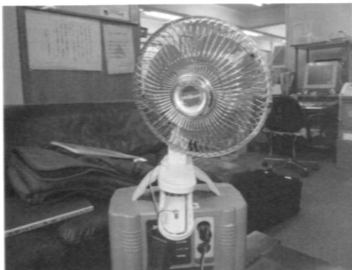
専用扇風機「そよ風」 専用コントローラーバッテリーに 2台まで接続可能。
